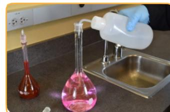
4. Der Kolben wird mit entionisiertem Wasser aufgefüllt.
