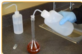
2. Der Kolben wird mit entionisiertem Wasser aufgefüllt. Die resultierende Lösung ist 100 mg/L Rhodamin WT.
