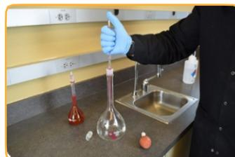
3. Um eine Konzentration von 500 µg/L zu erhalten, pipettiert man 5 ml der 100 mg/L-Lösung in einen 1000-mL-Kolben.
