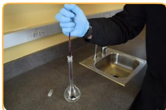
1. Beginnen Sie mit einer 2,5%igen Rhodamin-WT-Lösung. Pipettieren Sie 1,0 mL der Lösung in einen 250 mL Messkolben der Klasse A.
