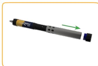
Entfernen Sie die Drossel aus dem Gerät.
