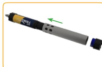
Setzen Sie die Drossel auf das Gerät im Kalibrierungsmodus.
